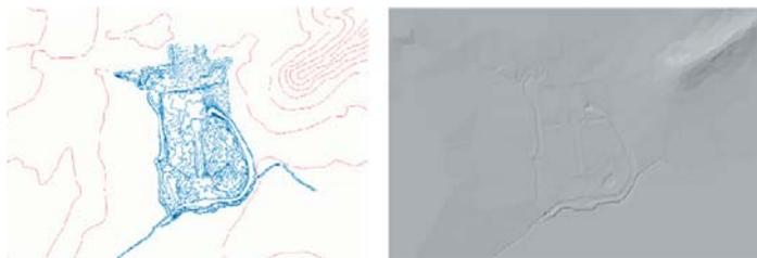
Abbildung 5 u. 6: Von Höhenlinien zum digitalen Höhenmodell (links, Quelle: EH; rechts: Anzeigebildschirm des digitalen Höhenmodells im LandXplorer, Blaik/ Lenné3D, Mai 2006)
